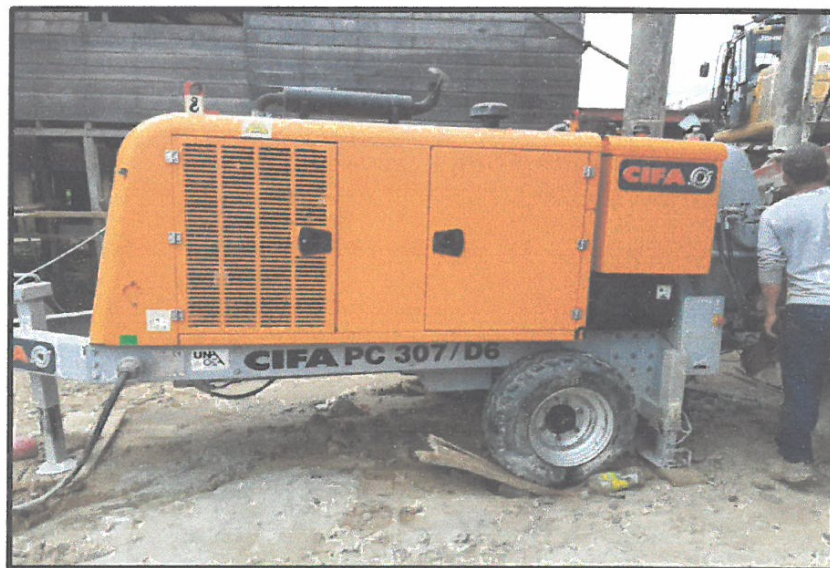
BOMBA DE IMPULSIÓN DE MORTERO EN OBRA.
